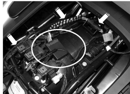
**10** Das Steuergerät SGS-09-02 wird über der Fahrzeugbatterie eingebaut.
