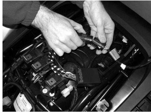
**9** Die Anschlussbox auf den gründlich gereinigten Kotflügel kletten.
