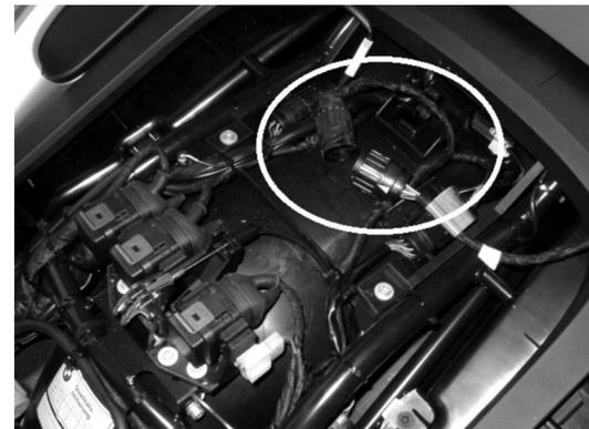
**8** Die Anschlussbox RUP-01-01 einschleifen.
