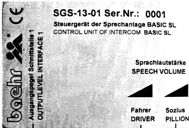
Auf dem Steuergerät der baehr BASIC SL befindet sich ein **Aufkleber**, der die Einstellmöglichkeiten am Gerät veranschaulicht.
