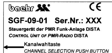
Um den eingestellten Kanal zu verändern, drücken Sie bitte mit einem dünnen, spitzen Gegenstand, z.B. einem kleinen Schraubendreher, einem dünnen Bleistift oder ähnlichem auf die Taste im Loch. Die Zahl im Sichtfenster erhöht sich bei jedem Druck um eins.
